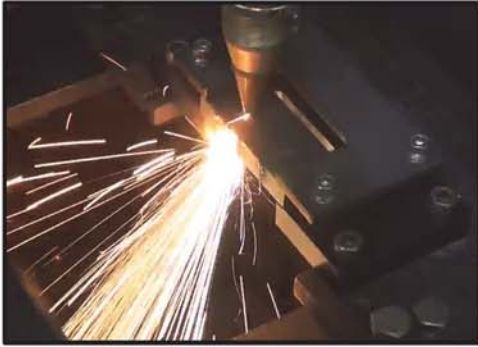
ファイバーレーザーによる炭素鋼ブロックの溶断実験
